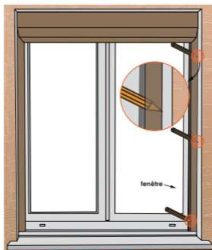
Pose sous linteau
